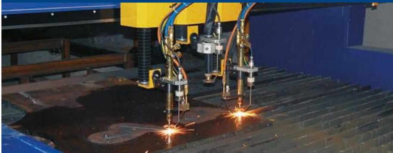
I cannelli per macchine da taglio Härds sono progettati per tutte le applicazioni di taglio macchina. Sono robusti, affidabili e tagliano fino a 380 mm. Sono disponibili nei modelli a due o tre tubi per tutti i gas combustibili, entrambi con i sistemi di miscelazione fino a 0,015 bar.
